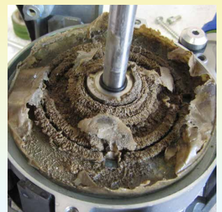
Realität in der Sauganlage: Wenn die Reinigung fehlt (Dürr Dental)
