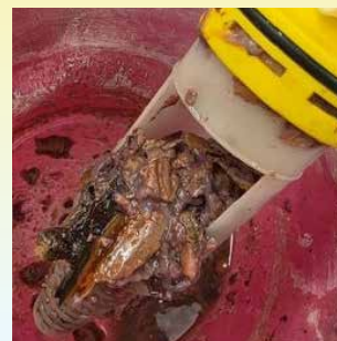
Realität in der Sauganlage: Wenn die Reinigung fehlt (Dürr Dental)
